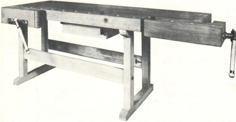
Hobelbank, extraschwere Ausführung, mit französischer Vorderzange, Stahlspindeln, gußeiserner Parallelführung in der Vorderzange und Eisenführung in der Hinterzange.
